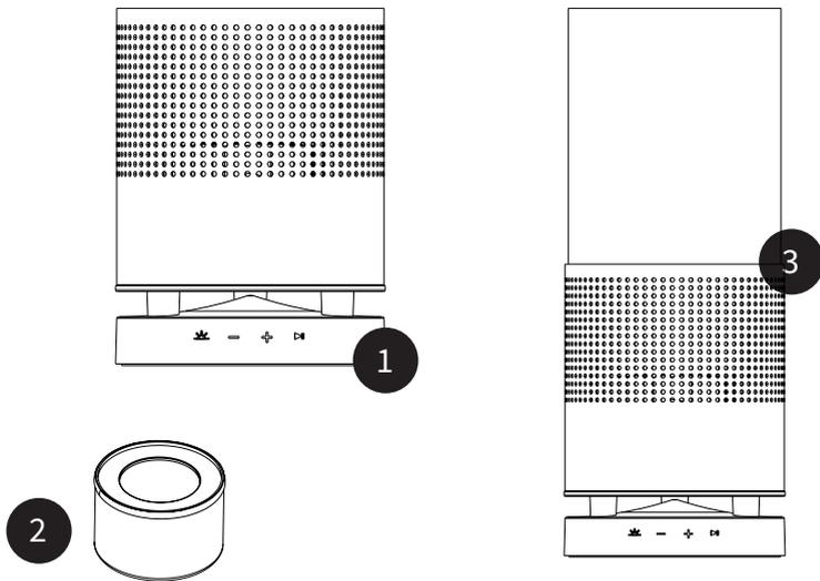
1. Nehmen Sie das Unterteil aus der Transportbox und stellen es auf einen festen nicht entzündbaren Untergrund. 2. Füllen Sie nun das Ethanol in den Behälter. Die Flüssigkeit wird nun von der Brennwatte aufgenommen. Füllen Sie maximal so viel ein, bis die Brennwatte vollgezogen ist. Die Brenndauer richtet sich nach dem verwendeten Brennstoff. Beachten Sie beim Nachfüllen, dass der Behälter vollständig ausgekühlt ist.
